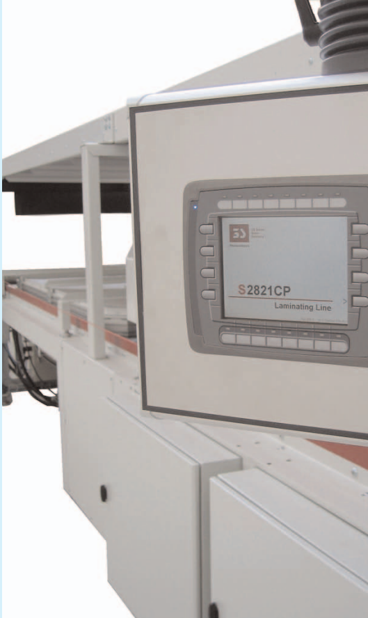
Laminierstrasse S2821CP zum semi- und vollautomatischen Laminieren von Solarmodulen. Die Steuerung erlaubt eine freie Programmierung des Prozessablaufs sowie eine umfassende Kontrolle des Laminierprozesses.
