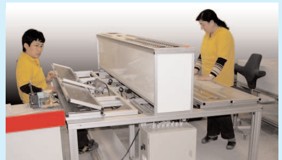
String-Löttisch ST220 mit zwei Arbeitsplätzen zum manuellen Löten von Solarzellen.
